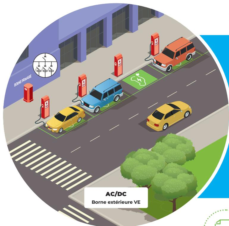
Les Points De Charge sont raccordés à un Point De Livraison (PDL) spécifique et les places de parking sont partagées entre les usagers. Un contrôle d'accès, de la gestion de puissance ainsi qu'un service de télégestion et télépaiement sont obligatoires.
